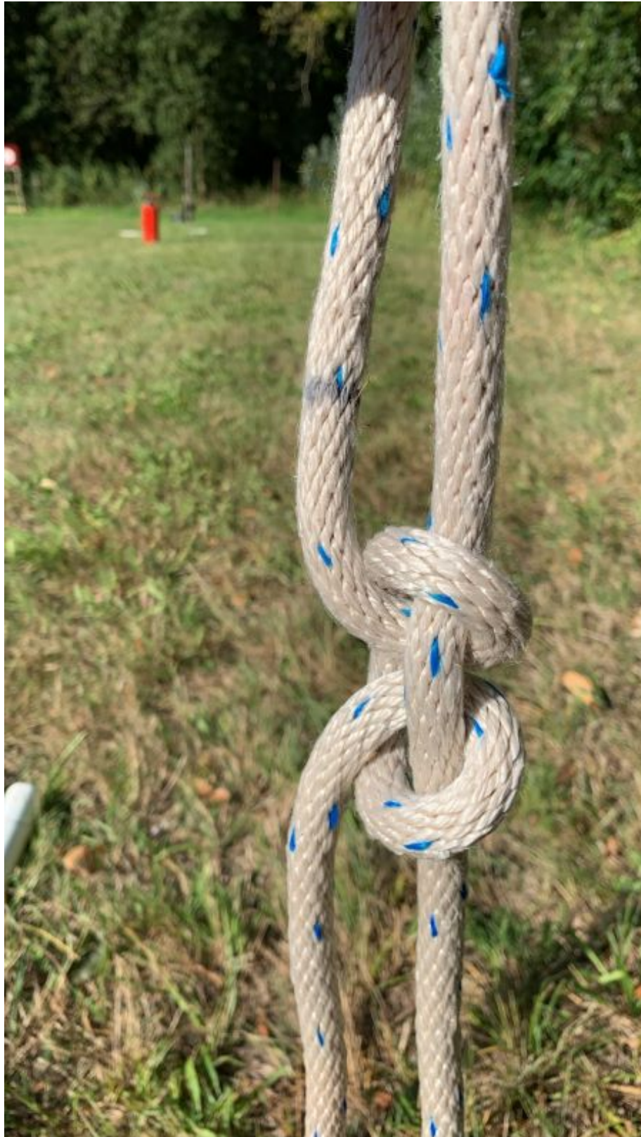
Abbildung 12: Kreuzknoten falsch - es wurde ein Ankerstich hergestellt.
