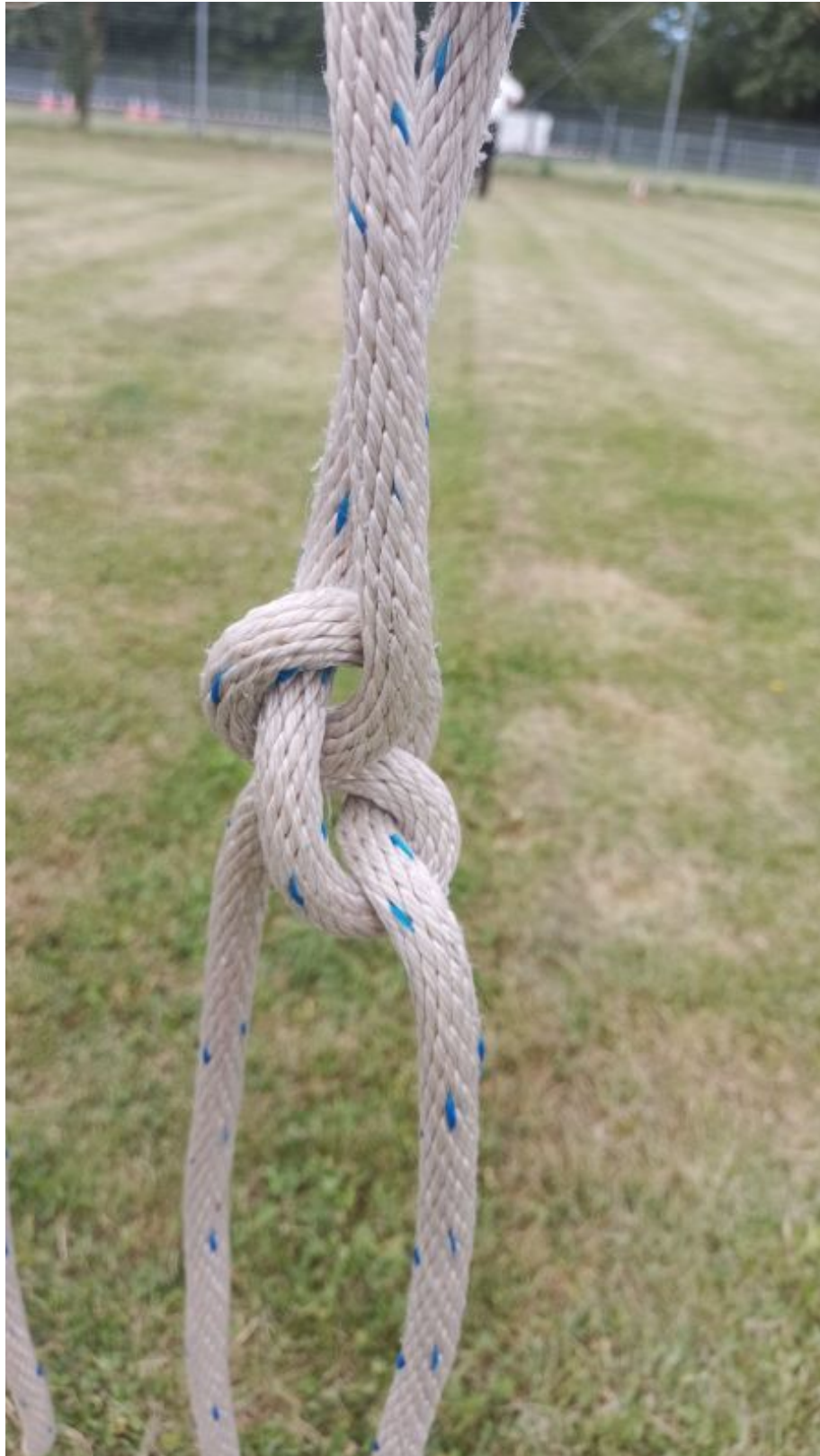
Abbildung 14: Kreuzknoten falsch - verdreht und damit nicht sofort erkennbar.
