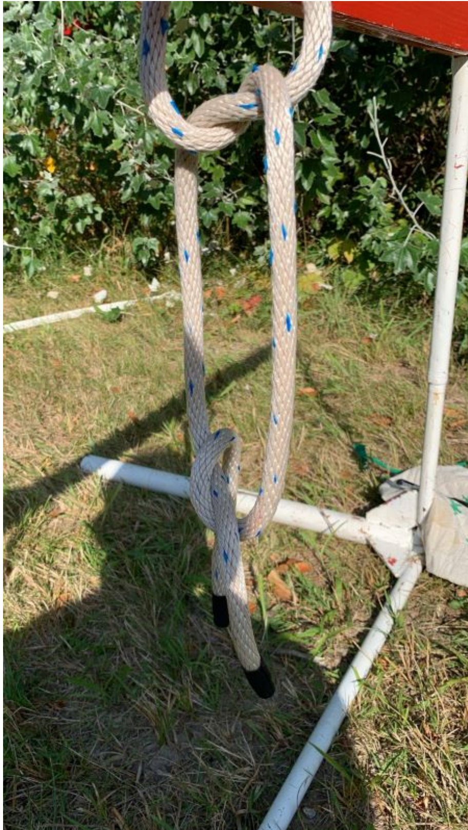
Abbildung 8: Kreuzknoten falsch - separate, nicht als Knoten erkennbare Schlaufen.
