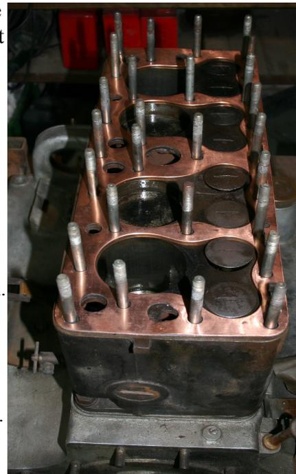
*Motor mit neuer Kopfdichtung*
