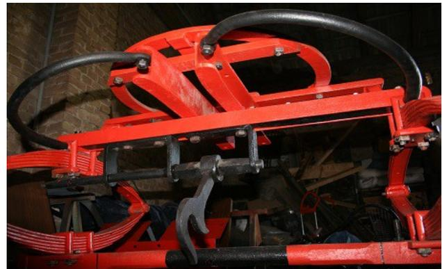
*Vordere mehrfarbige Achse mit Drehkranz und Federpaketen einer Koebe HDS*
