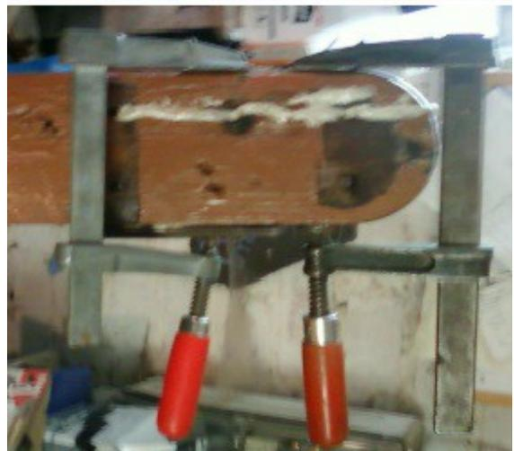
*Bruchstellen Verleimen und unter Druck aushärten lassen*
