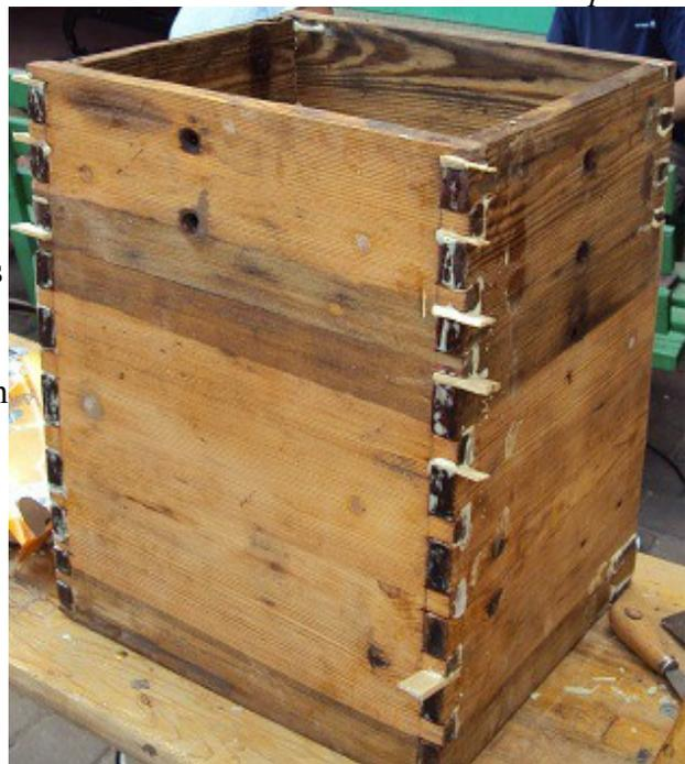
*Schwabenschwanzverbindungen mit neuen Holzkeilen aufgefüllt und verstärkt*
