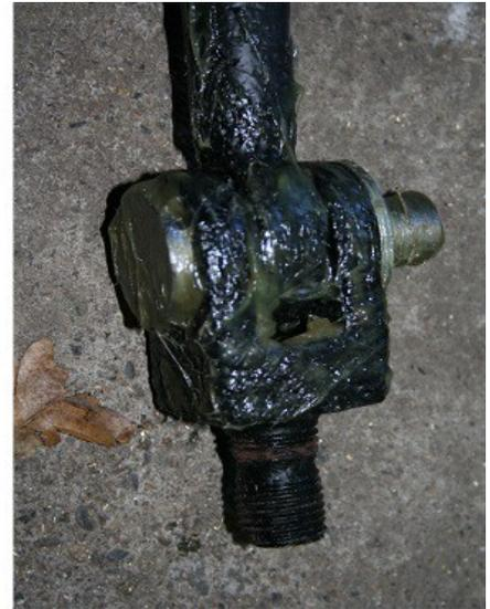
*Gelenk im Kolben, Verbindung zur Kolbenstange*
