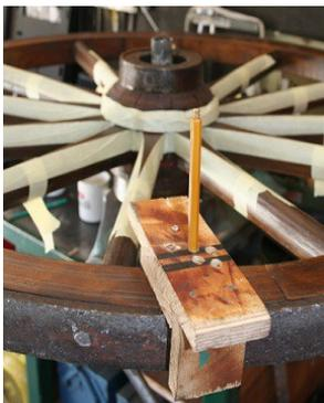
*Li: Einfaches selbstgebautes Hilfswerkzeug zum Vorzeichnen für das Auftragen der Begleiter*
