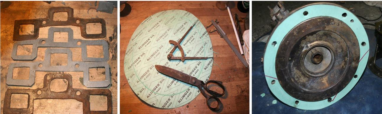
*Die meisten Dichtungen können selbst angefertigt werden. Das spart Geld. Alle Dichtungen sollten erneuert werden. Keine Dichtmasse aus der Kartusche verwenden! Bauteile von alten Fetten und Ölen immer befreien und neu abschmieren*
