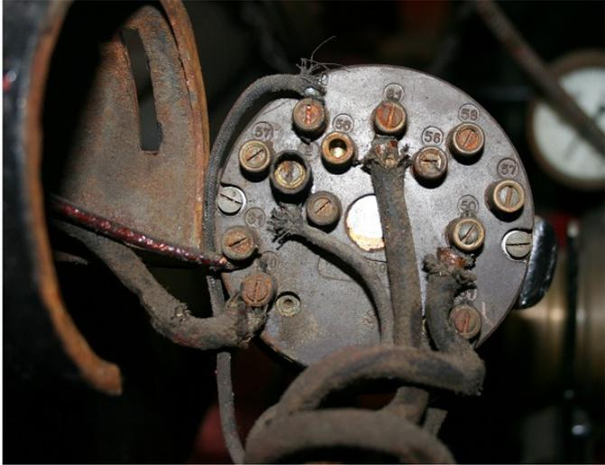
Es muss vor der Demontage genau der Verlauf und die Klemmanordnung der Leitungen ermittelt und dokumentiert werden.
