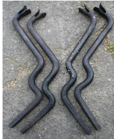
*Handschmieden einzelner Bauteile (Aufnahme Schlauchhaspel an einer Lafettenspritze)*
