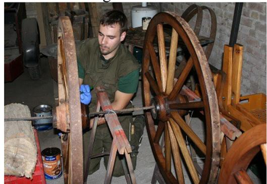
Die meisten Holzspeichenräder eiern bei der Fahrt massiv. Das liegt daran, dass die Lagerbuchse in der Radnabe ausgeschliffen ist. Eine neue Buchse aus Grauguss nachfertigen zu lassen, steht in keinem Verhältnis zur Nutzung der HDS. Für die zu erwartende geringe Laufleistung reicht es auch, ein dünnes Kupferblech um die Radaufnahme an der Achse zu legen. In Verbindung mit viel Fett dreht sich dann das Rad wieder einigermaßen gerade.
