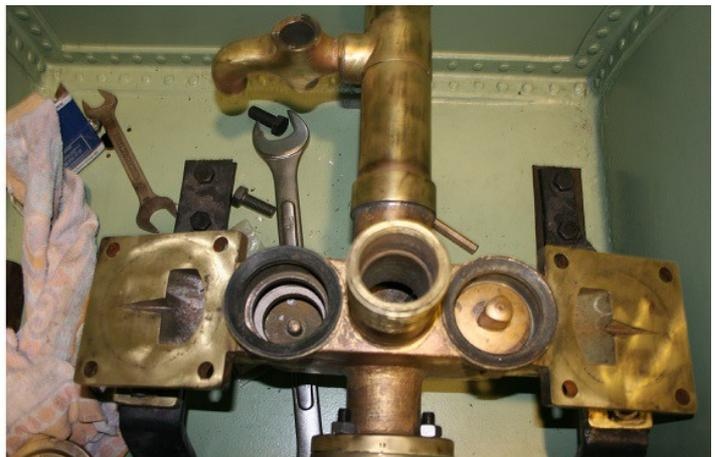
*Ventilgehäuse mit Saug- und Druckanschluss*
