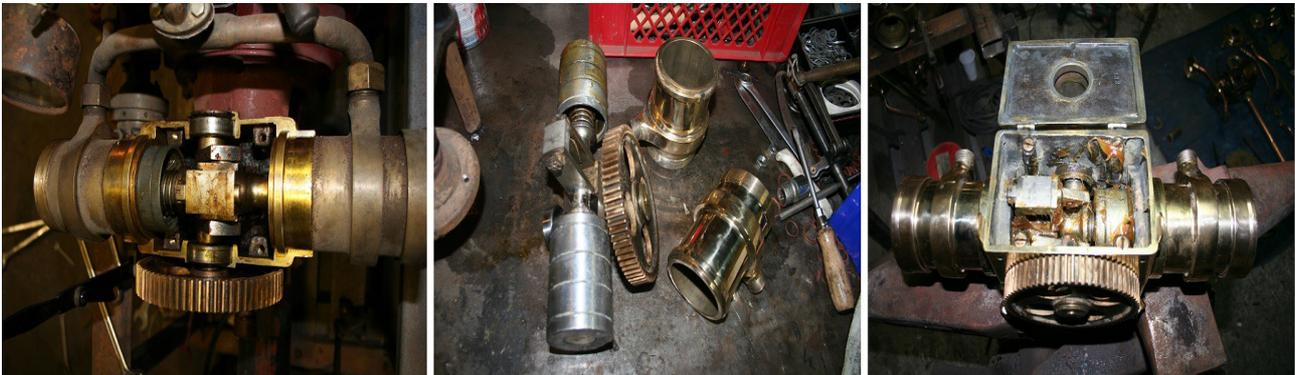
*Kolben der Pumpe mit Gehäuse (Lafettenspritze); Zerlegen, verharztes Fett entfernen und neu abschmieren*
