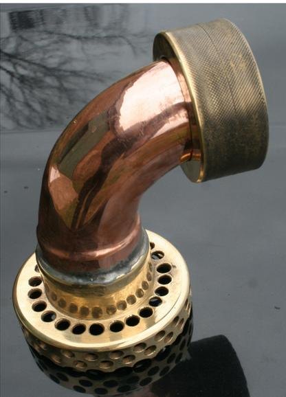
*Re. Der neu angefertigte Windkessel zum Umschalten von Tank- auf Saugbetrieb; Li. neuer Saugstutzen am Pumpwerk im Wassertank einer HDS*
