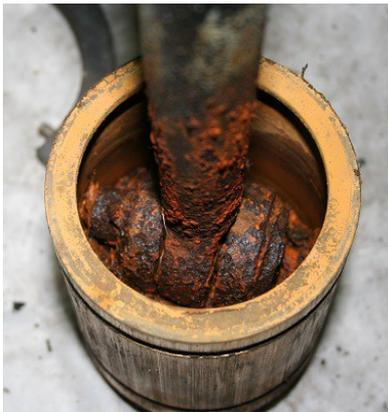
*Beispiel links, Kolben einer Koebe HDS, völlig fest gerostet. Rechts das ausgedrehte Gelenk mit neuem Lagerbolzen, wieder frei beweglich.*
