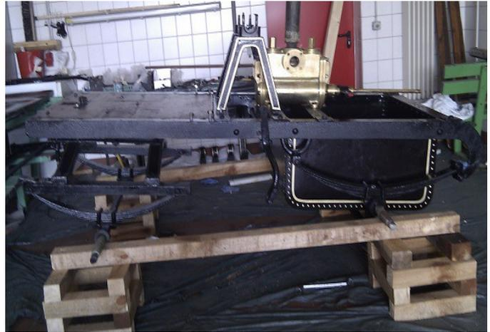
*Stabile Unterkonstruktion und sicherer Stand*
