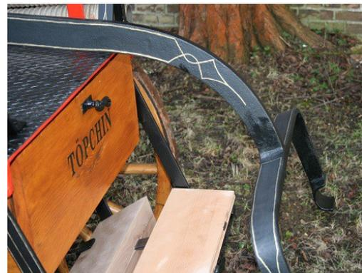
*Re: Druckarm einer Koebe HDS, Begleiter erzeugt frei Hand mit Schlepperpinsel*
