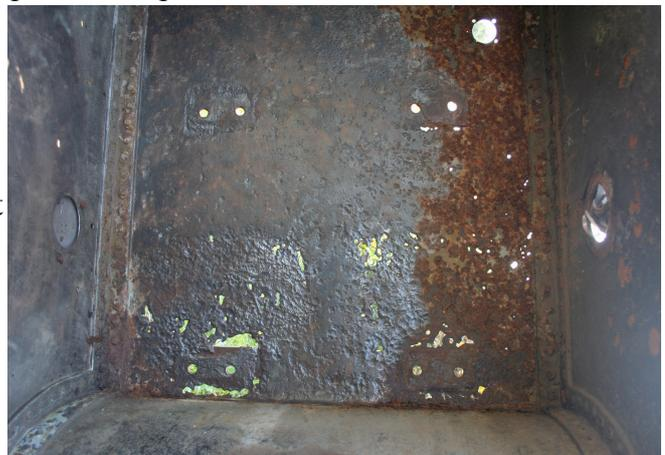
Lediglich am Wassertank ist das Strahlen angebracht, denn man erkennt danach im Gegenlicht besonders gut alle Löcher. Häufig muss danach der Boden des Tanks ausgetauscht werden.
