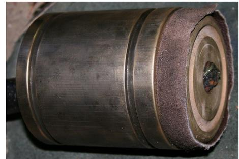
Der Bereich von Pleuelstangen war früher mit Wachskordeln abgedichtet. Hier dürfen heutzutage gern moderne Dichtmittel wie Teflonschnüre verwendet werden.
