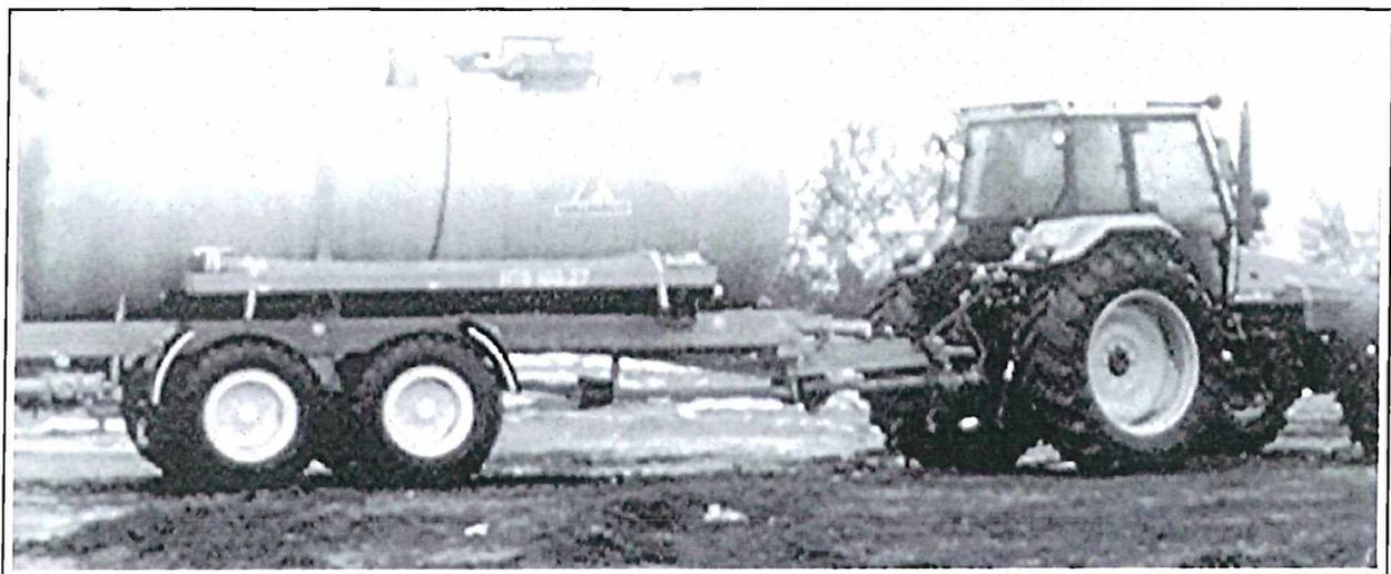
Bauart des HTS-Tankanhängers (HTS 103.27) der Annaburger Nutzfahrzeug GmbH. Der Behälter hat ein Fassungsvermögen von 10 500 l. Eine Kolbenpumpe (3000 l/min bei 8 bar) ermöglicht sowohl eine rasche Wasseraufnahme als auch die Wasserabgabe über ein Wenderohr (Wurfweite ca. 62 m) bzw. einen B-Anschluß,
