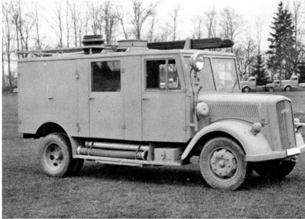
LF 8 Opel Blitz, Baujahr 1944 – Aufbau von Magirus – aus Hartfaserplatten
