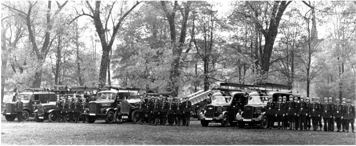
**Fahrzeugbestand der Freiwilligen Feuerwehr Spremberg 1942 – typisch für diese Zeit. Zu erkennen sind die zwei ursprünglichen kommunalen Fahrzeuge (offene LF 10 u. 12 aus den 1920er Jahren), sowie ergänzend dazu die Anfang der 1940er für den Luftschutz gelieferten 2 x LF 15 und 2 x LF 8.**
