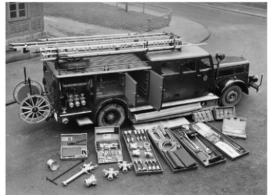
***Kraftfahrleiter KL 26 und Kraftfahrstrolche KS 25 nach Norm RLM***
